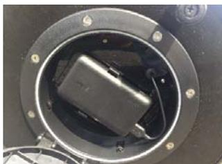
USBのコネクタを接続すると、バッテリーの残量を示す青いランプが点灯します。4つ点灯時がフル充電です。必要に応じて、充電して下さい。
