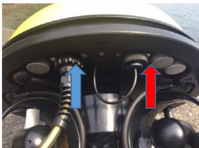
ケーブルリールのコネクタを左側の差込口(青矢印)に奥まで差し、根元のネジをしっかりと締めて下さい。右側(赤矢印)は充電器用の差込口です。締まっていることを確認して下さい。
