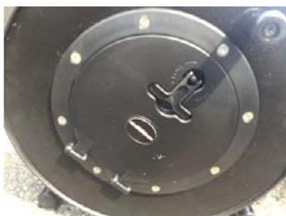
ケーブルリールの側面にバッテリーが格納されています。反対側にはケーブルリール固定ネジがあります。使用時に緩めて下さい。
